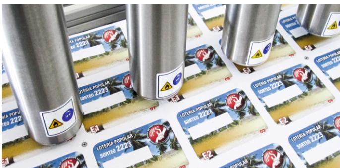
**WINJET3 Mailing** – ПО, созданное на базе WINJET3 Standard, для печати переменных данных. WINJET3 Mailing синхронизируется с внешними файлами и отправляет полученные данные на принтер/принтеры. Идеальное решение для печати на конвертах, лотерейных билетах, ваучерах и т.п.
